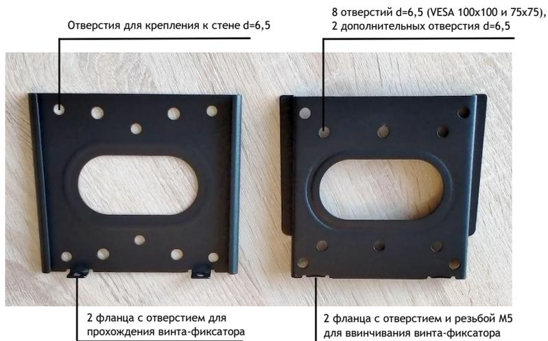
Часть для крепления на стену (А)
